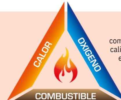
El sistema de supresión de incendios de Fogmaker ataja los tres lados del triángulo del incendio: el calor, el oxígeno y el combustible. El sistema se despliega cuando la zona protegida se calienta demasiado y rocía agua nebulizada que expande y ahoga el enciendo. El agua nebulizada también enfria la zona durante mucho tiempo, como mínimo el doble en comparación con otros sistemas certificados\* - lo que evita la reavivación.
